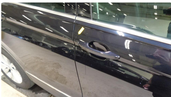
1.1 Dør foran høyre side lakksår med bulk
