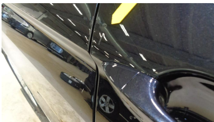
1.1 Dør foran høyre side lakksår med bulk
