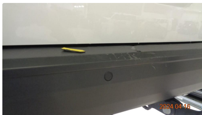
1.1 Noen riper i plast på fangerkappe bak
