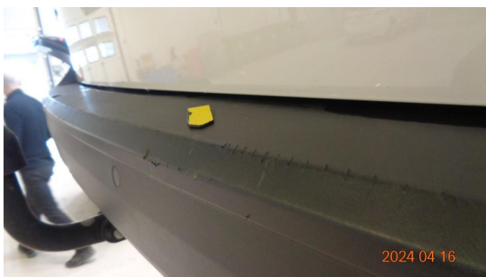
1.1 Noen riper i plast på fangerkappe bak
