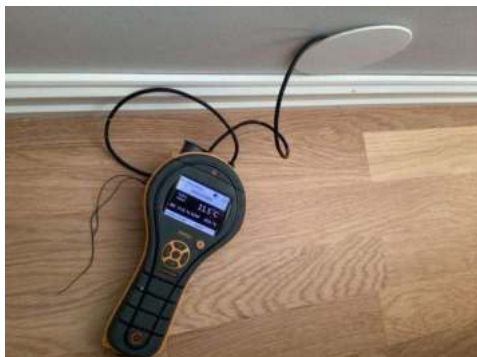
Rf måling 57,6 % ved 20 grader (31.05.2024)
