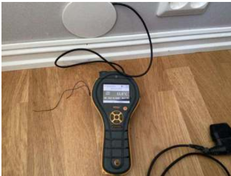
Rf måling 54,6% ved 20,4 grader ( 31.05.2024)
