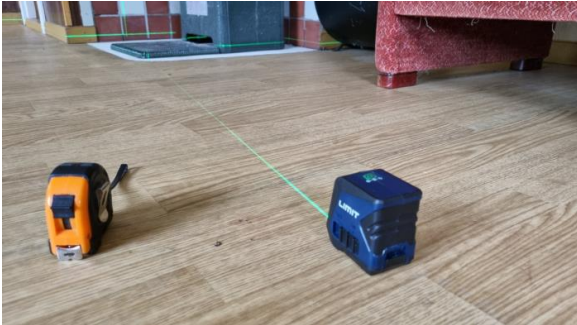
Måling av planavvik.
