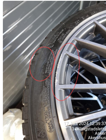
1.4 Kantkjørt felg, Kantkjørt felg og dekkskade, høyre forhjul, vinter
