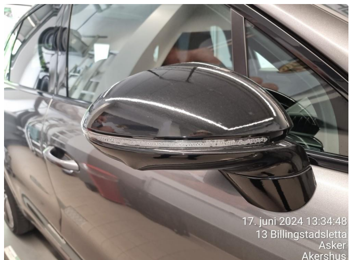
2.1 Vann/dugg, Fukt i blinklampe, høyre sidespeil
