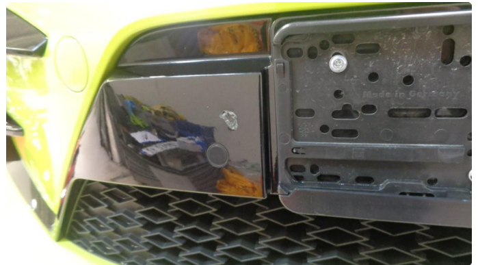
1.2 Lite sår i fangerkappen foran venstre side og på svart felt ved siden av reg.skilt foran
