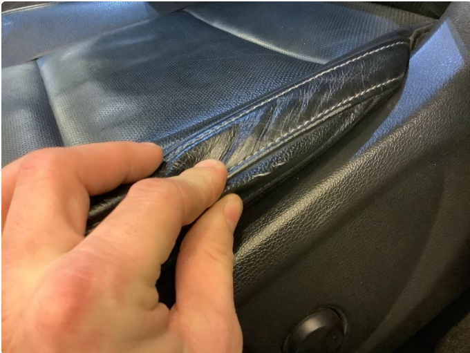
1.1 Små sprekker i sitteputevange venstre fram
