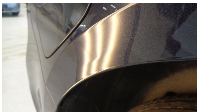
2.2 Skade med bulker høyre bakskjerm - utbedres
