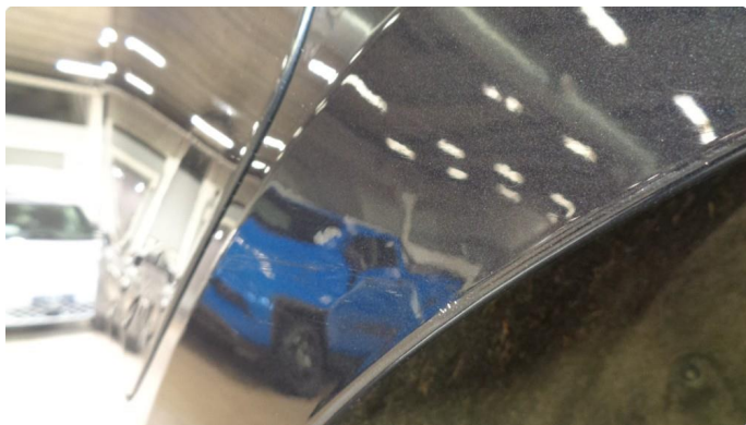
2.2 Skade med bulker høyre bakskjerm - utbedres
