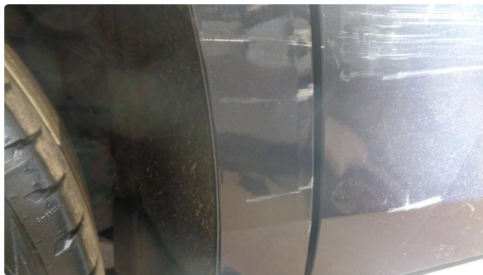
2.2 Skade med bulker høyre bakskjerm - utbedres
