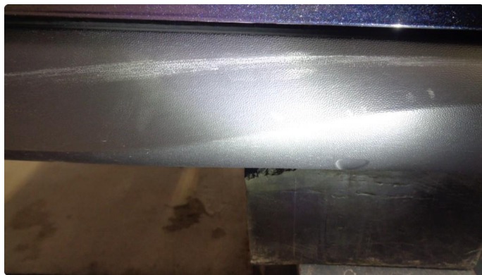
2.1 Bulk med lakkskade høyre skyvedør, skade/bulk inklusive bytte av nedre plast kanal pyntelist - utbedres
