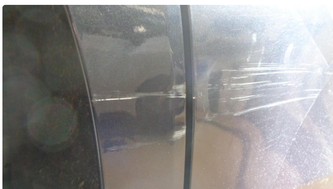
2.2 Skade med bulker høyre bakskjerm - utbedres
