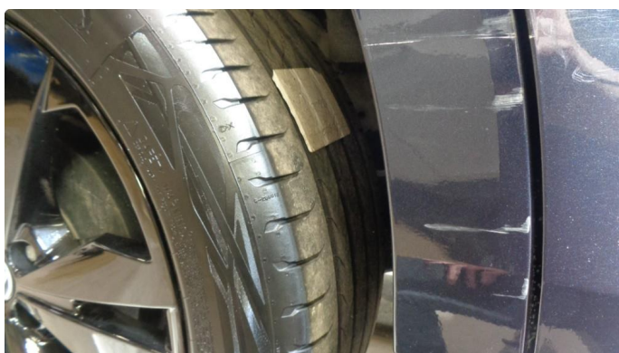
2.2 Skade med bulker høyre bakskjerm - utbedres
