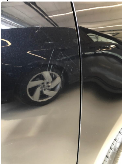
1.3 Noen riper på høyre fordør.
