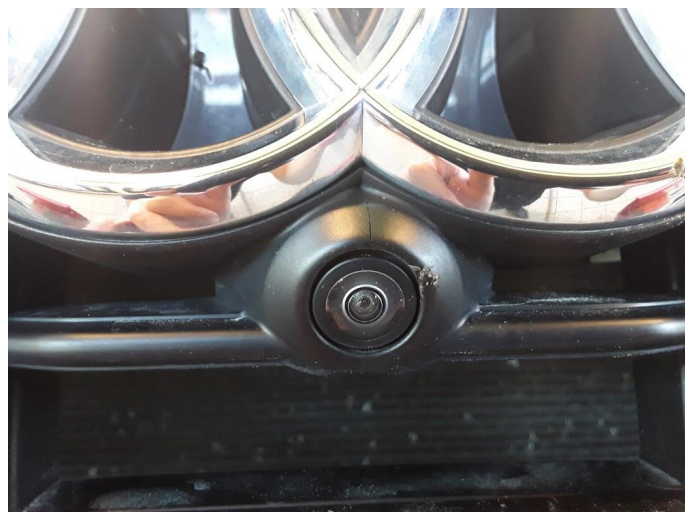
1.2 Liten sprekk i plast over front kamera.
