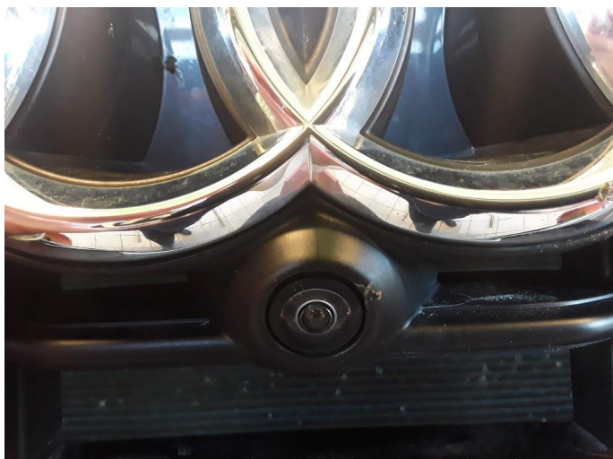
1.2 Liten sprekk i plast over front kamera.
