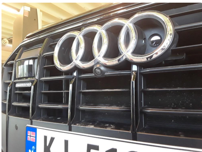
1.2 Liten sprekk i plast over front kamera.
