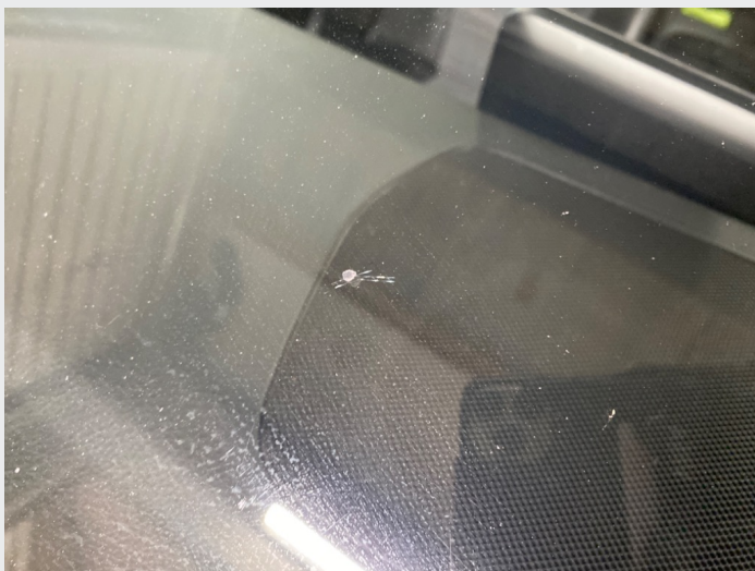
2.15 Steinsprut frontrute, er rep. Ellers mye skrubbsår på rute
