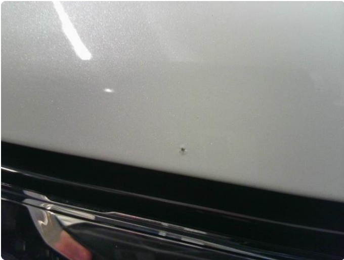
1.1 Noe steinsprut med rust
