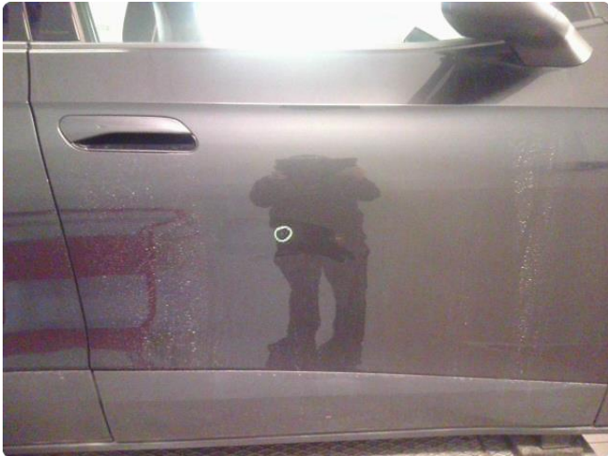
1.1 Steinsprut med rust
