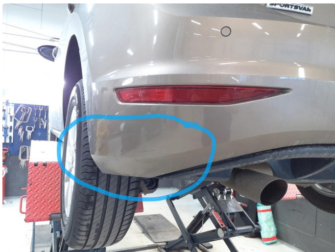
1.4 Ripe(r) ned til grunning
