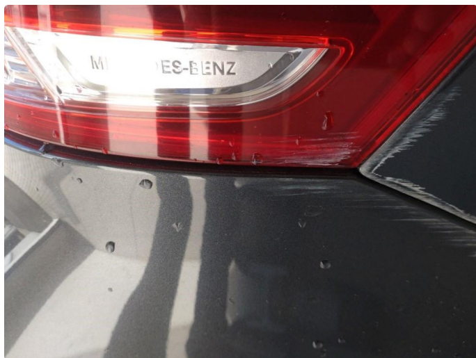
2.1 Defekt / sprukket glass
