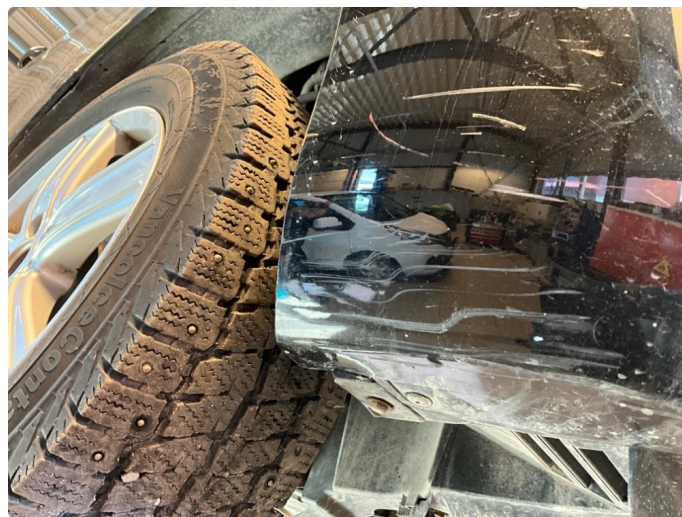
1.9 Riper på støtfanger. Venstre foran.
