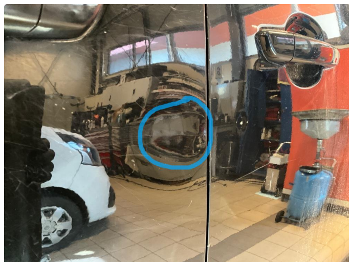
1.2 Bulk på skyvedør. Høyre bak.
