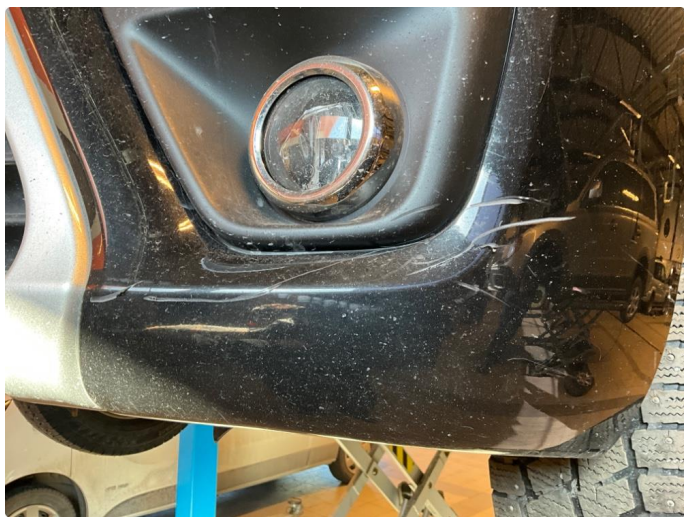
1.9 Riper på støtfanger. Venstre foran.
