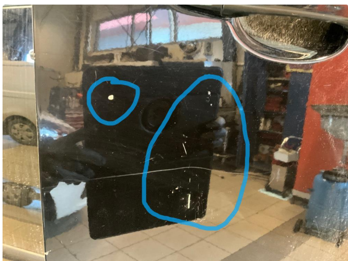
1.3 Bulk med lakkskade på dør. høyre foran.
