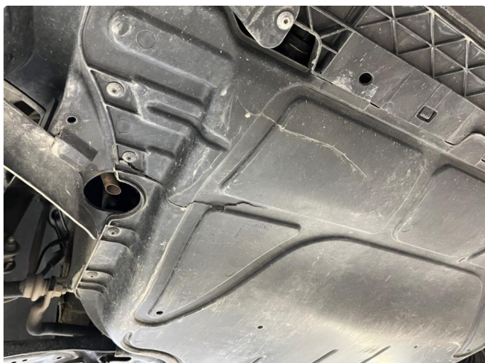
1.1 Sprekker i skliplate
