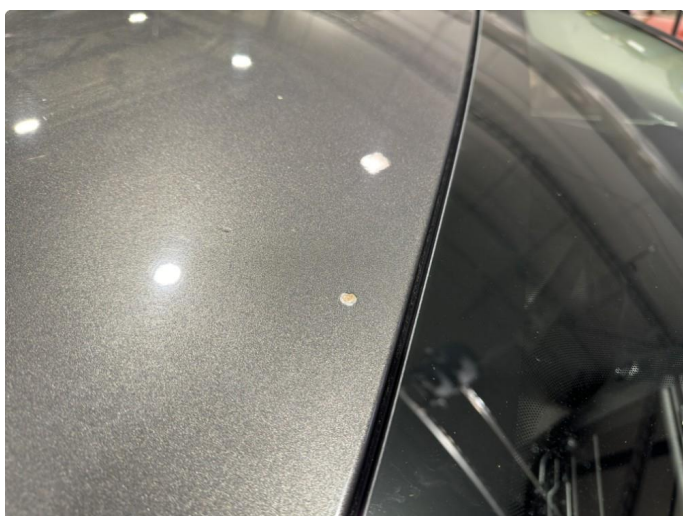
1.5 Lite merke med rust
