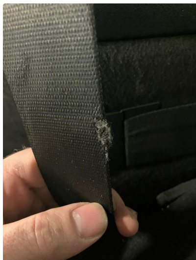
1.1 Skade på belte Kommentar: Blir utbedret på verksted
