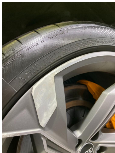
1.1 Kantkjørt venstre sommerfelg foran - har blitt pusset ned. (Notert for info)
