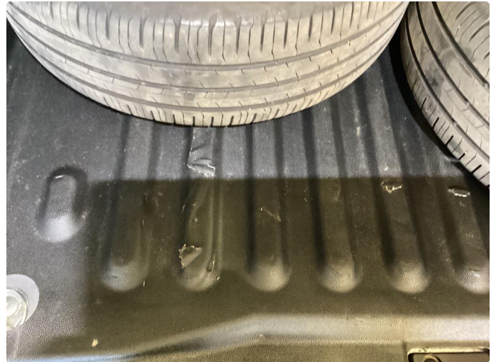
2.1 Gulv plast i varerom har noen hull (slitasje)
