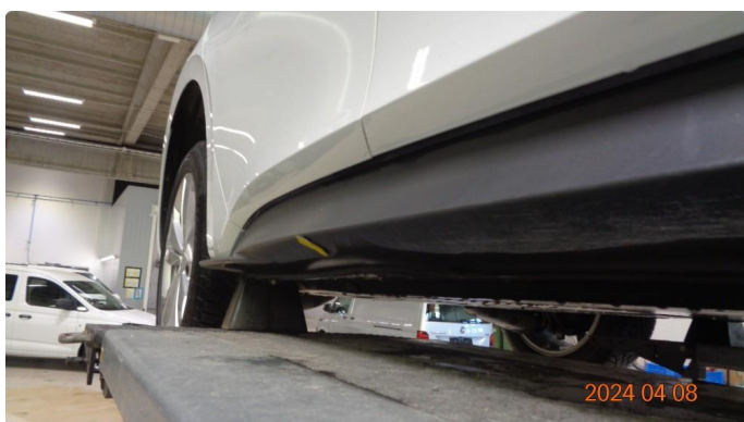
1.1 Skadet kanaldeksel høyre side ,liten bulk .
