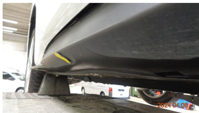
1.1 Skadet kanaldeksel høyre side ,liten bulk .
