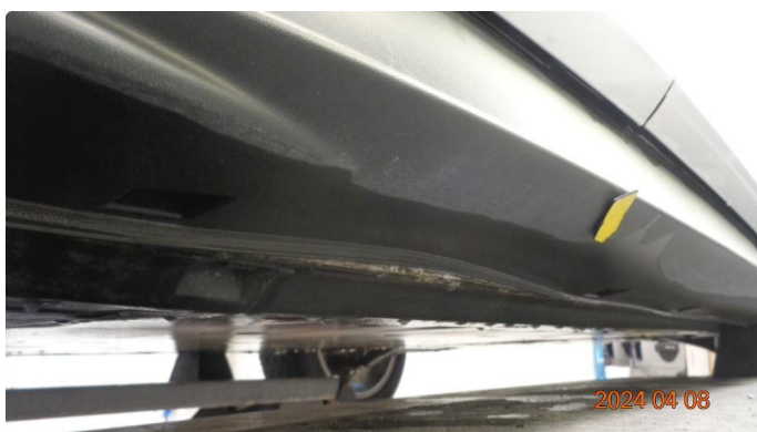
1.1 Skadet kanaldeksel høyre side ,liten bulk .
