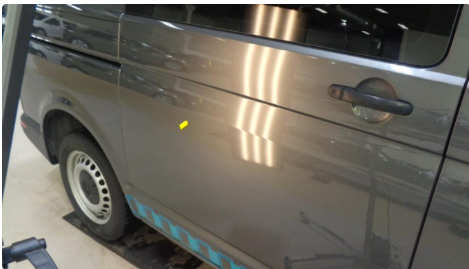
1.2 Liten bulk høyre skyvedør
