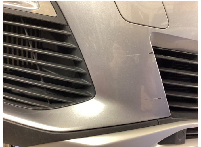
1.2 Liten ripe på frontfanger (blir flekket !)
