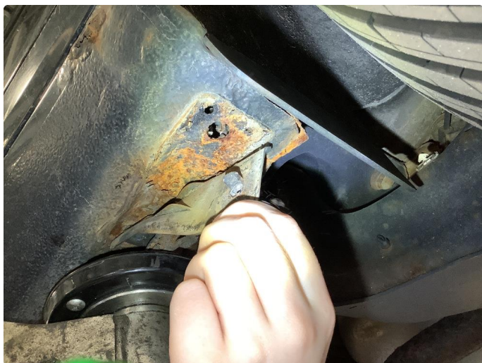
1.3 Mye rust i bærende konstruksjoner
