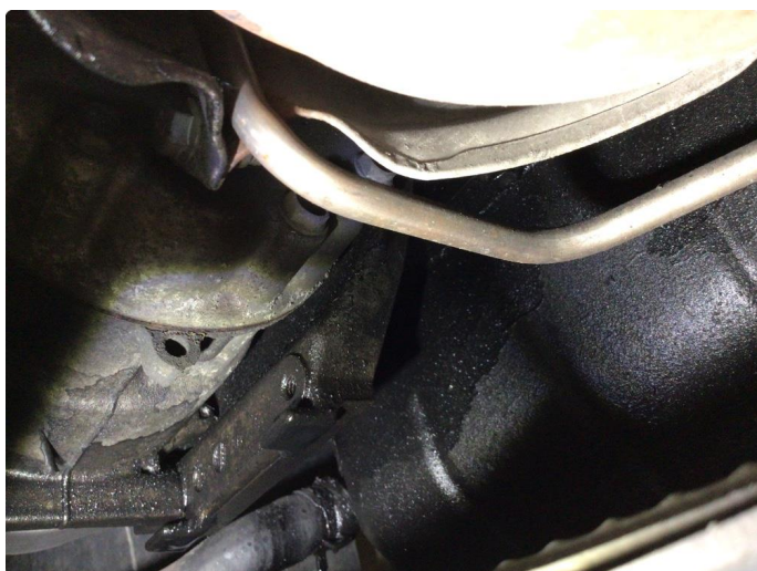
4.2 Oljelekkasje fra motor
