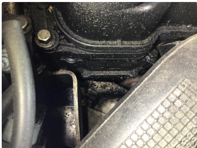
4.2 Oljelekkasje fra motor
