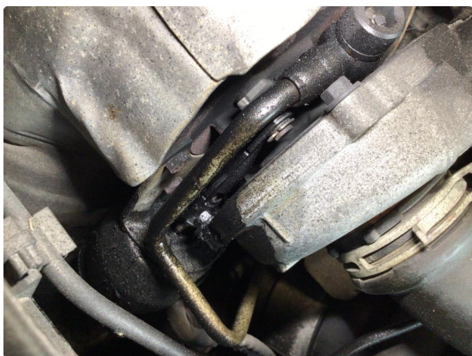
4.2 Oljelekkasje fra motor
