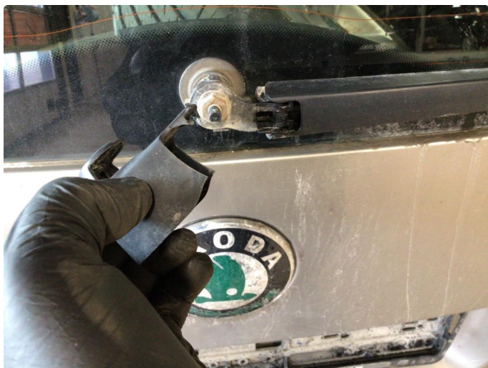
1.7 Deksel over bakvisker defekt
