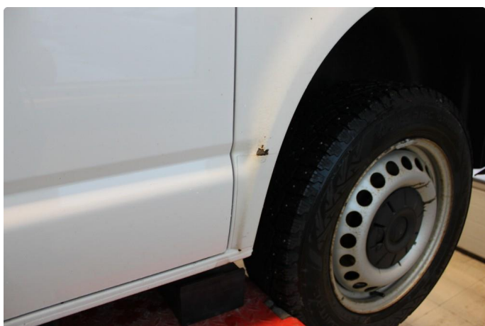
1.4 Rust i hjulbue foran og bak.
