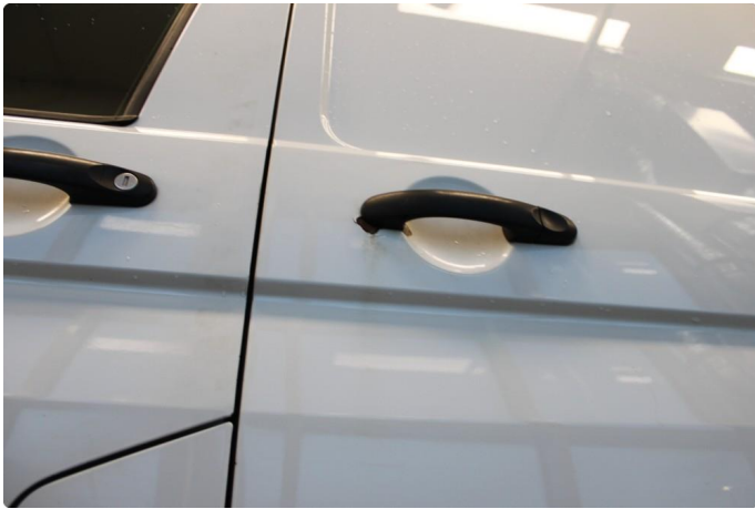
1.2 Rust på venstre skyvedør, flere plasser.
