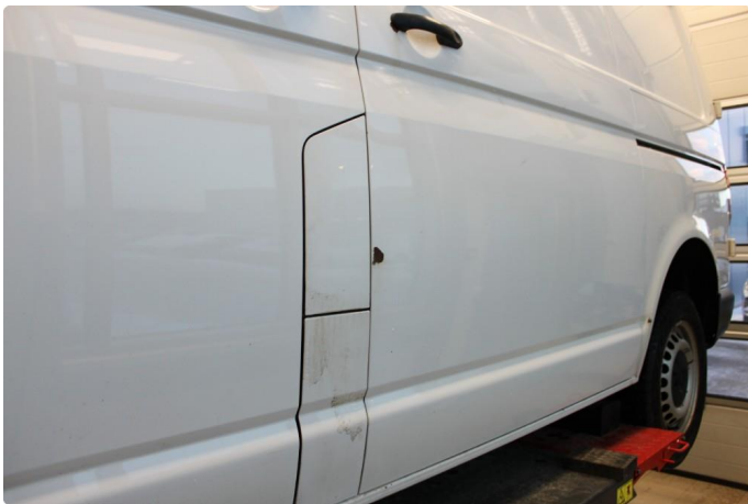
1.2 Rust på venstre skyvedør, flere plasser.
