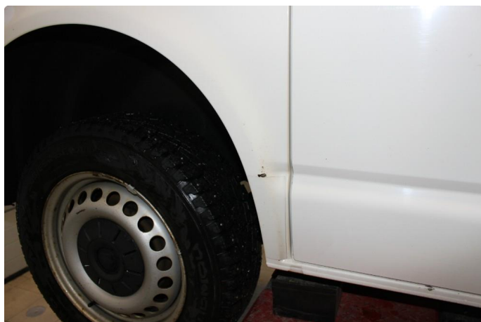
1.4 Rust i hjulbue foran og bak.
