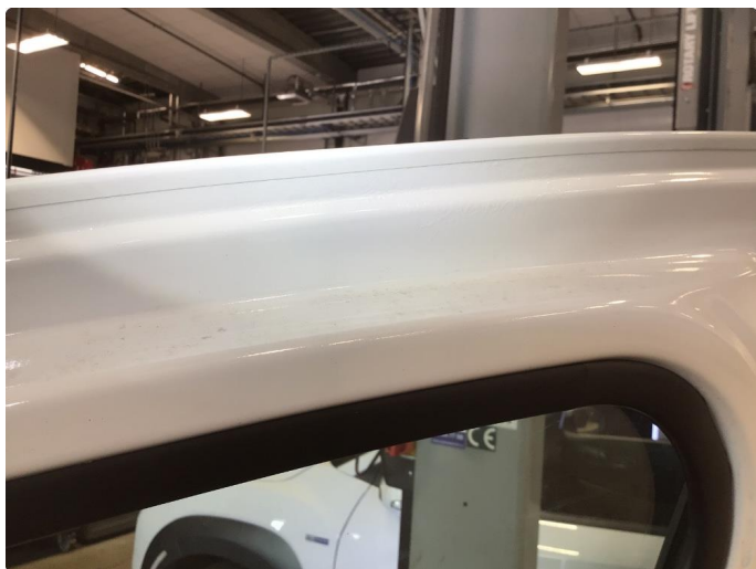
1.4 Rust i fals
