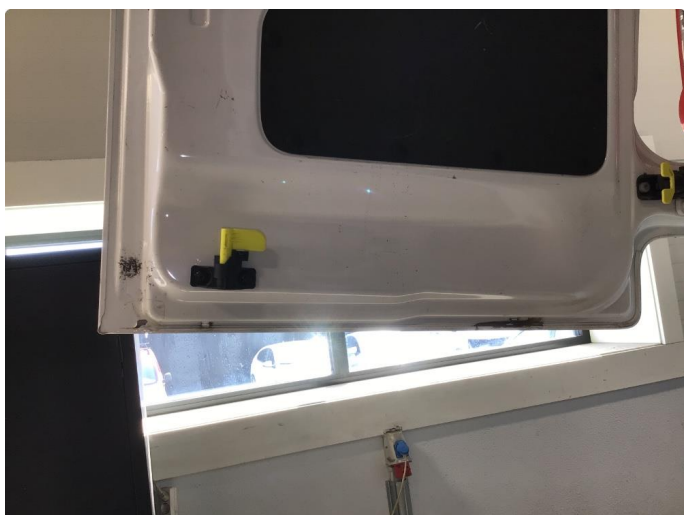
1.3 Rust i fals
