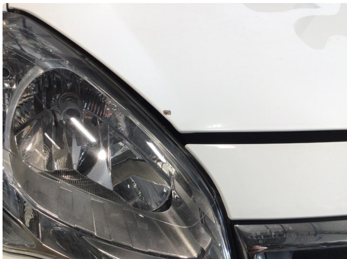
1.1 Lakkglass som er utbedret med pensellakk
