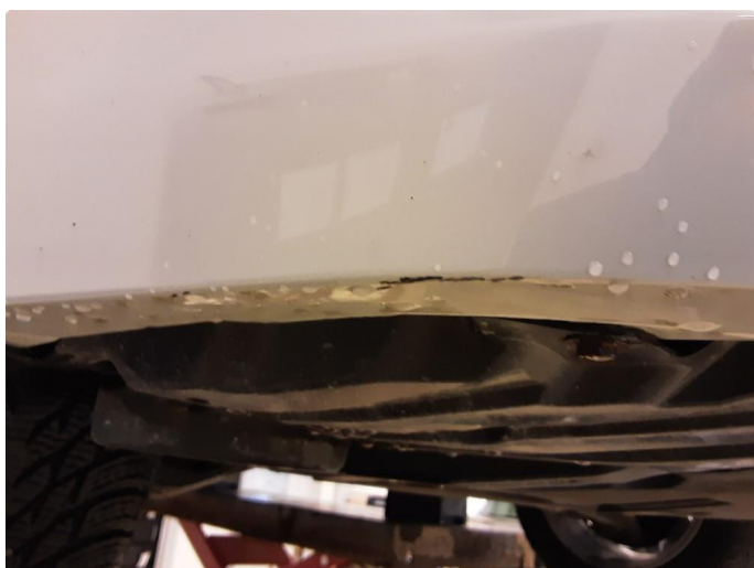
1.1 Ripe(r) ned til grunning
