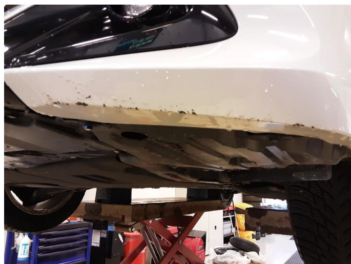
1.1 Ripe(r) ned til grunning
