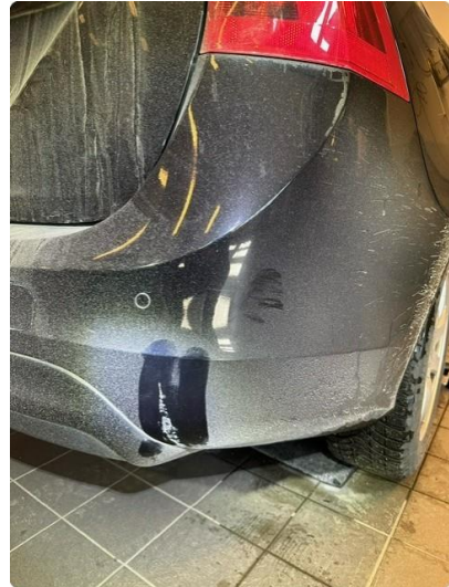
1.3 Skade, skade i plastikk utføres smart rep.
