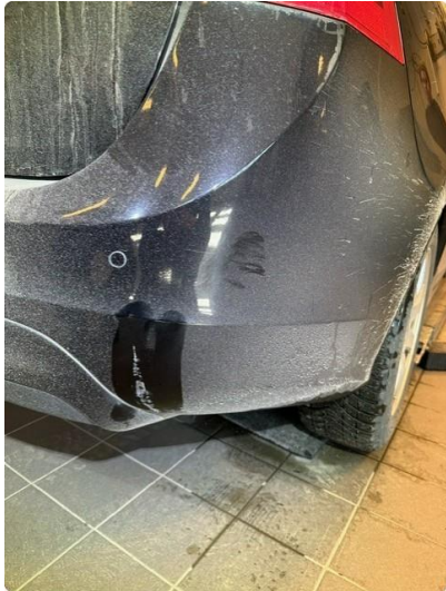
1.3 Skade, skade i plastikk utføres smart rep.
