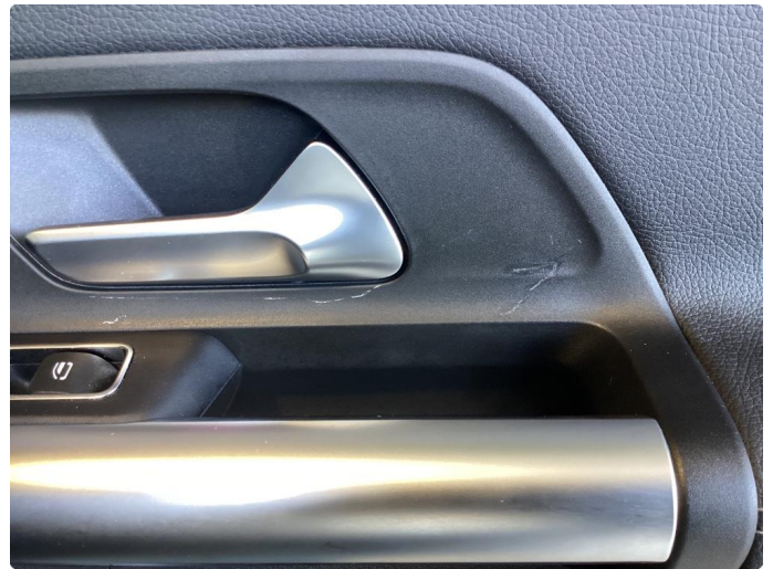
2.1 Skadet/merker etter utstyr
