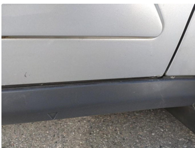
1.5 Steinsprut med rust
