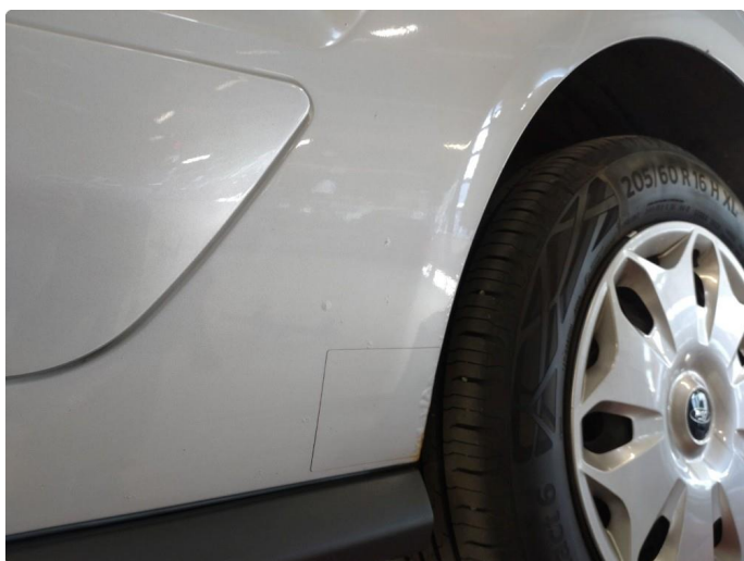
1.12 Steinsprut med rust
