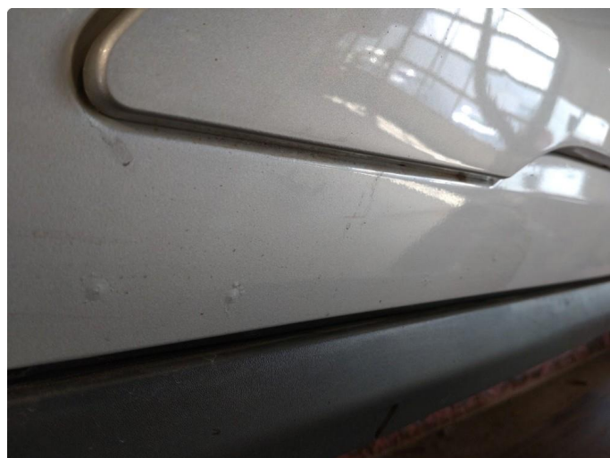
1.4 Steinsprut med rust
