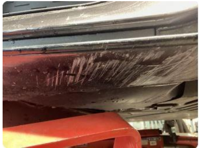
1.1 Noe riper under støtfanger foran.
