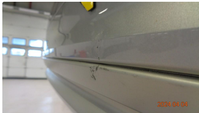
1.7 Lakksår + flere bulker støtfanger bak - pensles, bulker.
