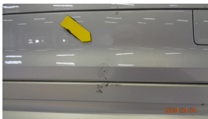
1.7 Lakksår + flere bulker støtfanger bak - pensles, bulker.
