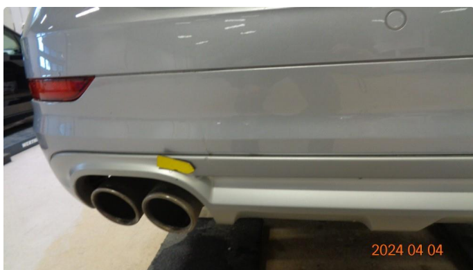
1.7 Lakksår + flere bulker støtfanger bak - pensles, bulker.
