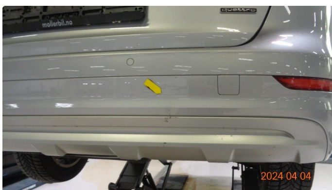
1.7 Lakksår + flere bulker støtfanger bak - pensles, bulker.
