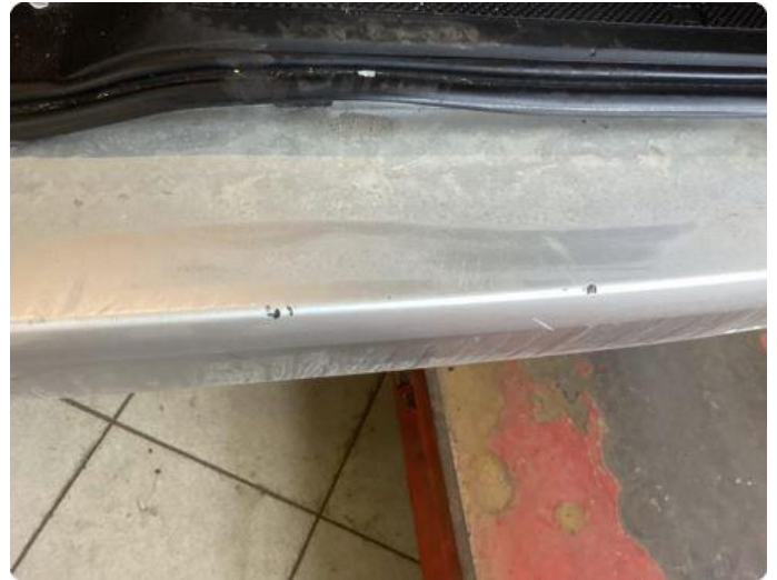
1.2 Noe riper på støttfangerbak.
