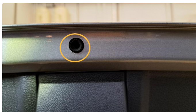
1.3 Påbegynt rust innvendig ved dreneringslange.
