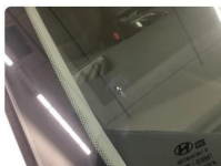
1.2 Steinsprut med sprekke utenfor synsfelt Forsikring
