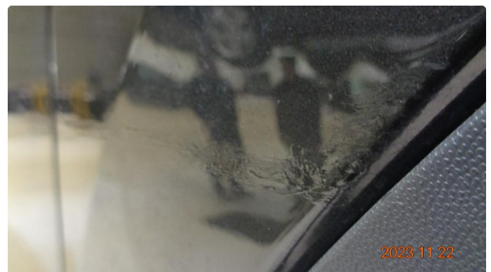
2.1 Riper ned til grunning og bulk høyre fordør, forskjerm og støtfanger foran høyre side - utbedres
