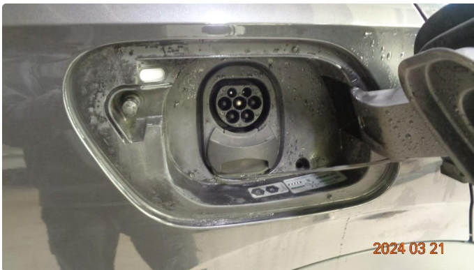
1.1 Ladeluke vil ikke lukkes - utbedres
