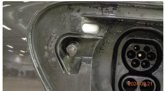
1.1 Ladeluke vil ikke lukkes - utbedres
