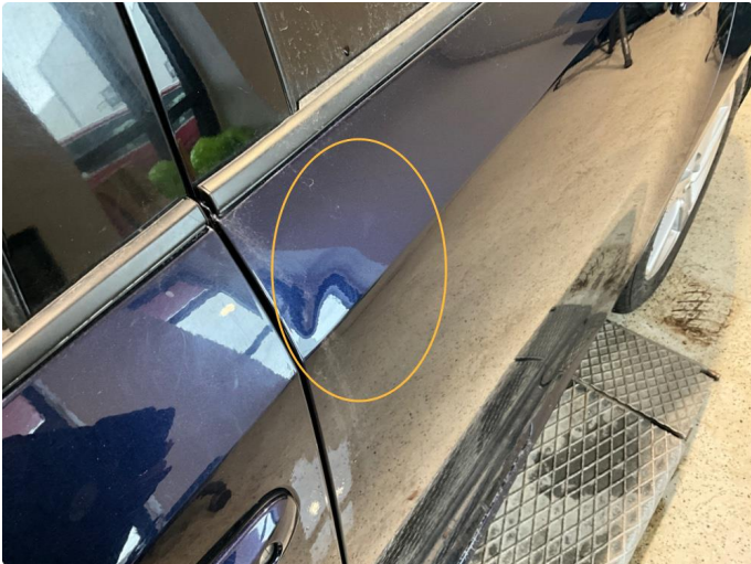
1.1 Veldig svak bulk i dør. Venstre bak.
