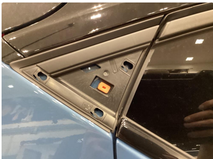
1.2 Løse/skadede lister - Byttet på garanti
