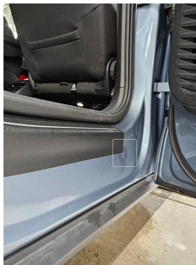
1.1 Liten bulk u/lakkskade på h.side bak
