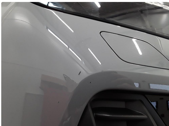
1.1 Noe steinslag. Normal bruksslitasje
