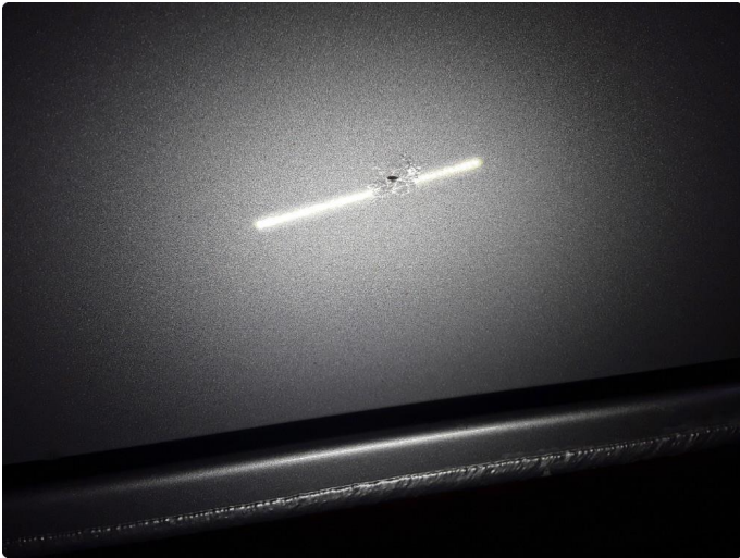
1.2 Steinsprut med korrosjon venstre skyvedør.
