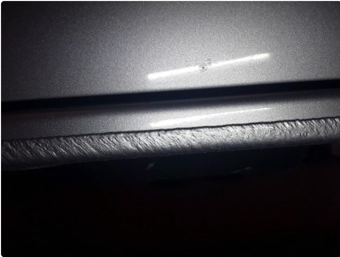
1.3 Steinsprut med korrosjon høyre skyvedør.
