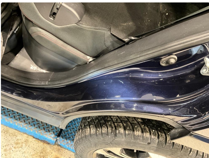
1.4 Noe slitasje og riper i døråpning. Venstre bak.
