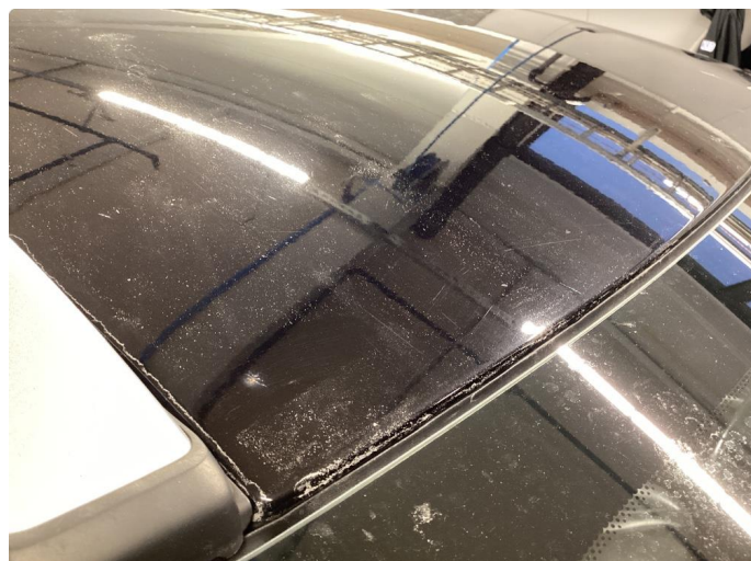
1.2 Steinsprut med rust
