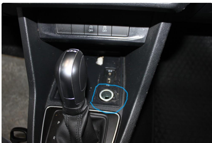
2.1 Defekt lokk 12 V uttak midtkonsoll foran.
