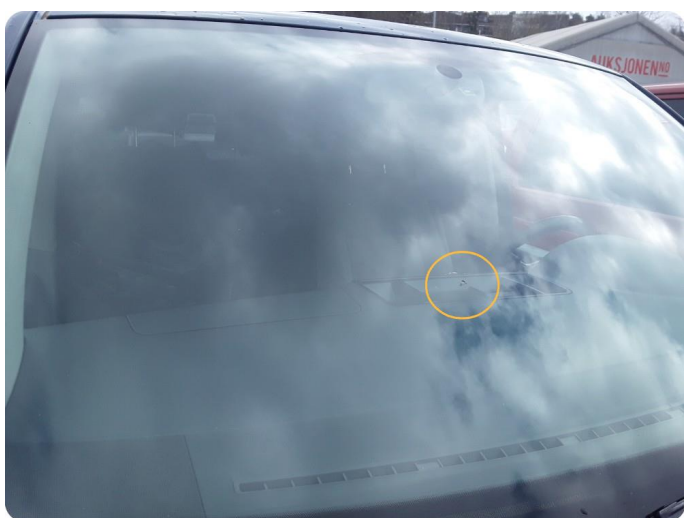
3.15 Steinsprut med sprekk
