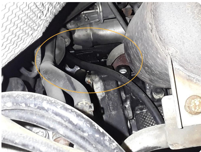
5.2 Oljelekkasje fra motor
