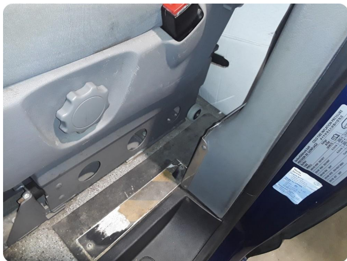
8.1 Øvrig opplysninger B-stolpe må bygges om til org tilstand av et godkjent verksted. Deretter må det godkjennes av SVV.
