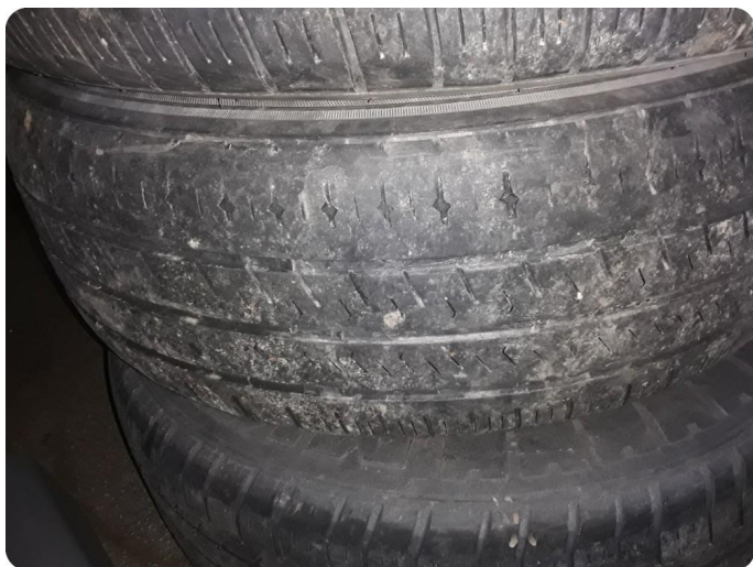
3.12 Skjev slitasje på sommerdekk -to stk
