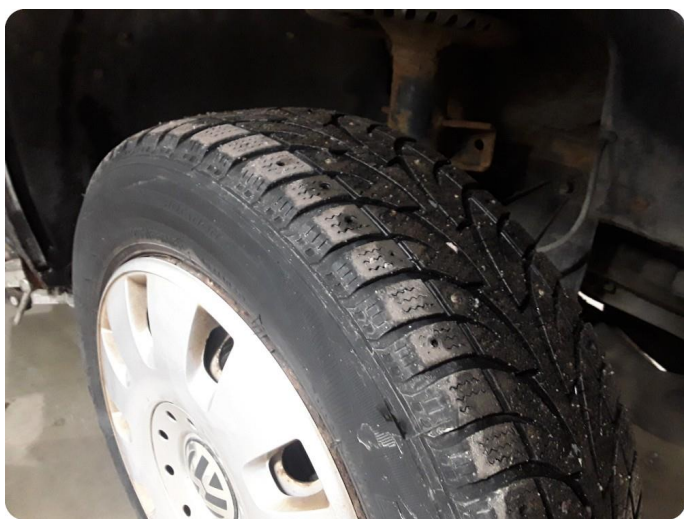
3.9 Piggdekk mangler pigger I alle dekk
