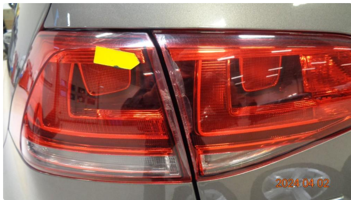
2.1 Krakelering i plast i baklykter
