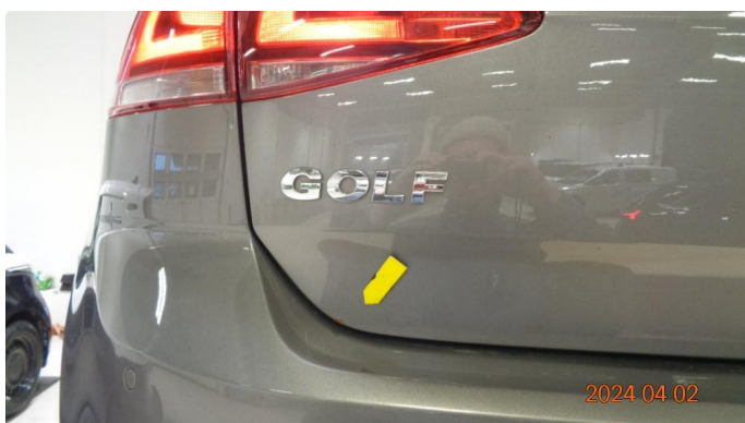
1.5 Litt overflaterust bakluke mot bakfanger venstre side
