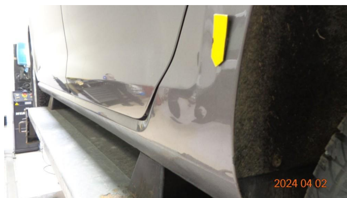
1.6 Bulker og rust venstre bakskjerm.
