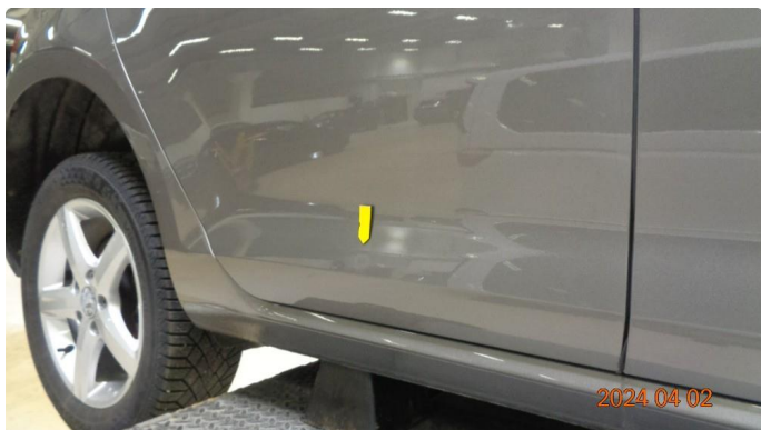
1.3 P-bulk høyre bakdør
