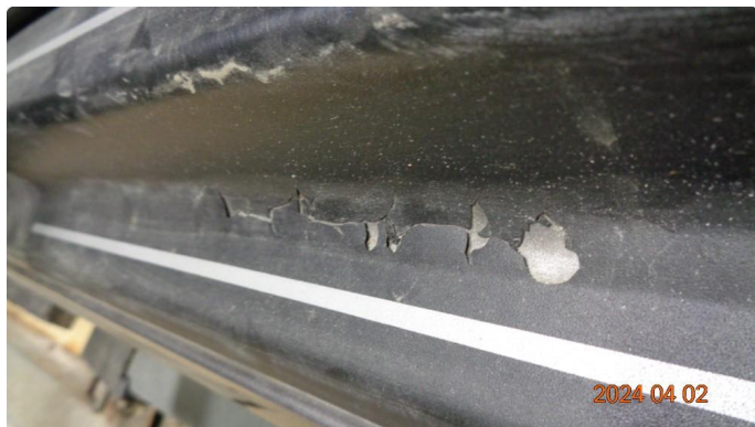
1.11 Venstre foran, skadet folie
