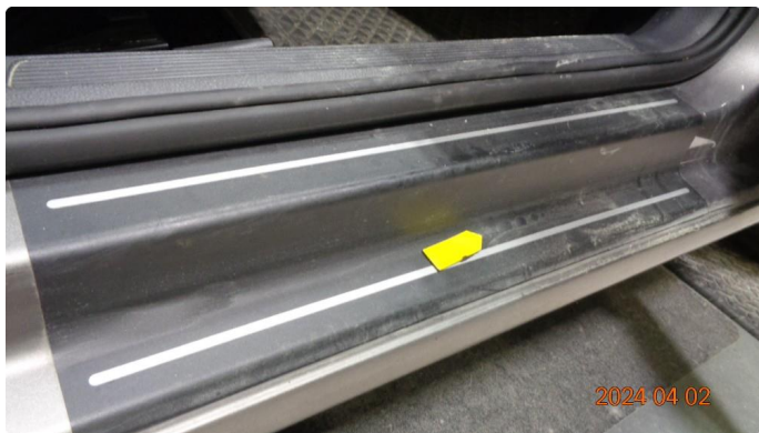
1.13 Blærer i folie til høyre innsteg foran
