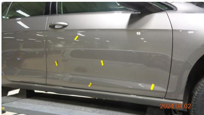
1.2 Venstre fordør og høyre fordør, flere lakkblærer
