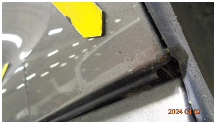
1.8 Rust høyre forskjerm
