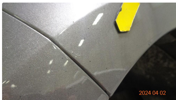
1.7 Rust høyre bakskjerm
