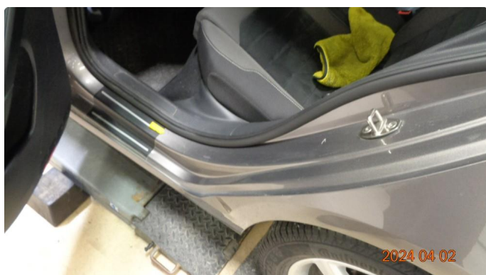
1.12 Lakkskade og ripe gjennom lakk venstre innsteg bak.
