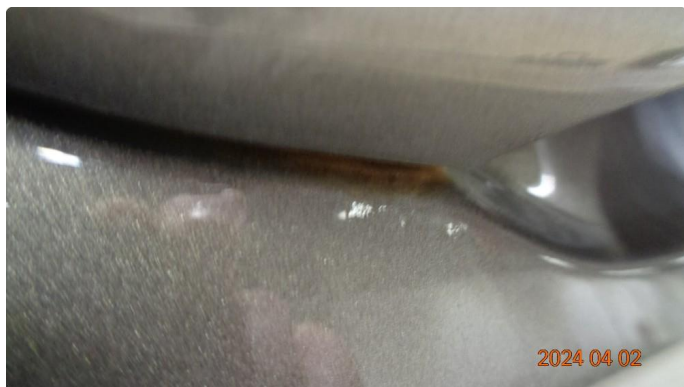
1.4 Overflaterust ved dørhåndtak venstre bakdør og høyre fordør.
