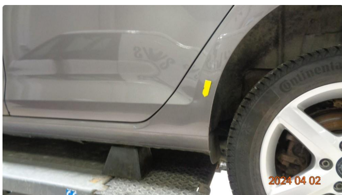
1.6 Bulker og rust venstre bakskjerm.
