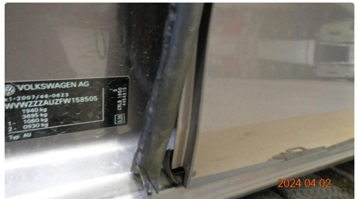
1.1 Skadet dørpakning begge bakdører i fremkant.
