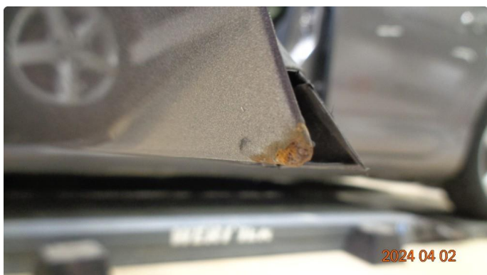
1.2 Venstre fordør og høyre fordør, flere lakkblærer
