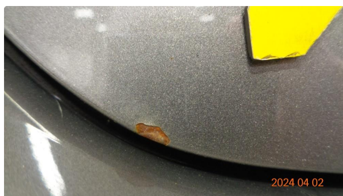
1.5 Litt overflaterust bakluke mot bakfanger venstre side
