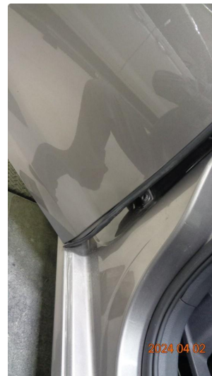
1.1 Skadet dørpakning begge bakdører i fremkant.
