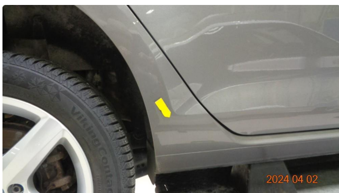
1.7 Rust høyre bakskjerm
