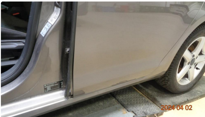
1.1 Skadet dørpakning begge bakdører i fremkant.
