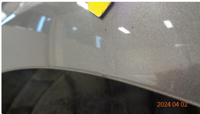
1.6 Bulker og rust venstre bakskjerm.
