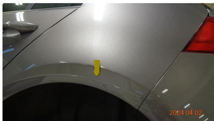
1.6 Bulker og rust venstre bakskjerm.
