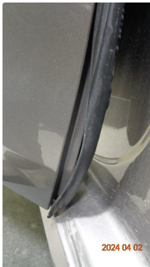
1.1 Skadet dørpakning begge bakdører i fremkant.
