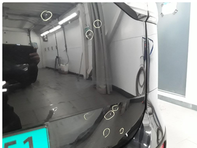
1.2 Noe lakksår på bakluken. Flekkes med lakkstift.
