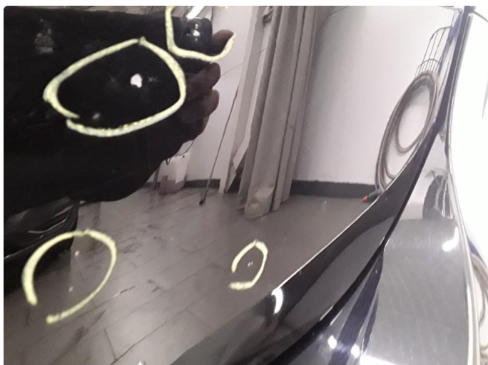
1.2 Noe lakksår på bakluken. Flekkes med lakkstift.
